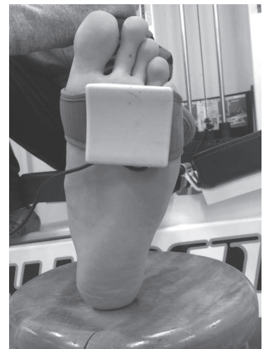
足底に設置した \mu TasF-1のセンサー
